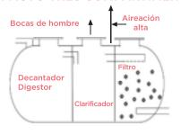
**NOTA:** Todos los decantadores digestores así como los compactos con filtro, incluyen tubo de llenado, tubo de vaciado y tubo para aireación. Ganchos de elevación en vacío a criterio de fábrica, o a petición del cliente.
