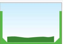
2 Hacer una solera de hormigón adecuado a la capacidad y dimensiones del depósito, vertiendo en la excavación hormigón de resistencia 175, esperar al secado del hormigón, introducir el depósito, asentarlo y nivelarlo.
