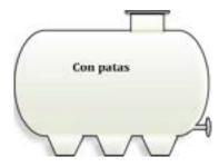
Nivel de tolerancia en dimensiones +/- 5 cm. Todos los depósitos de suministran con racor/brida de Ilenado, racor/brida de vaciado y rebosadero. Ganchos de elevación en vacío a criterio de fábrica o petición del cliente.
